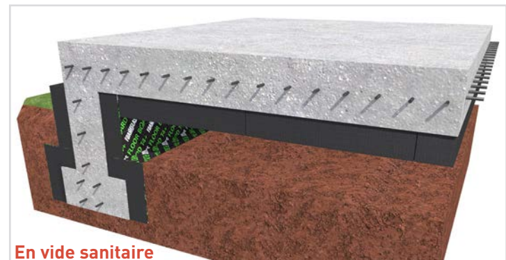
Sous dalle portée
