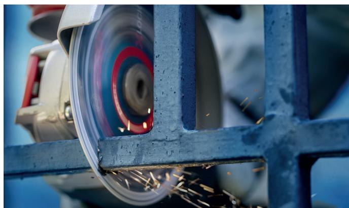
Le corps en acier du disque a été optimisé pour assurer une vitesse et une profondeur de coupe constantes. Doté d'ouvertures de refroidissement, il ne se déforme pas avec la chaleur.
