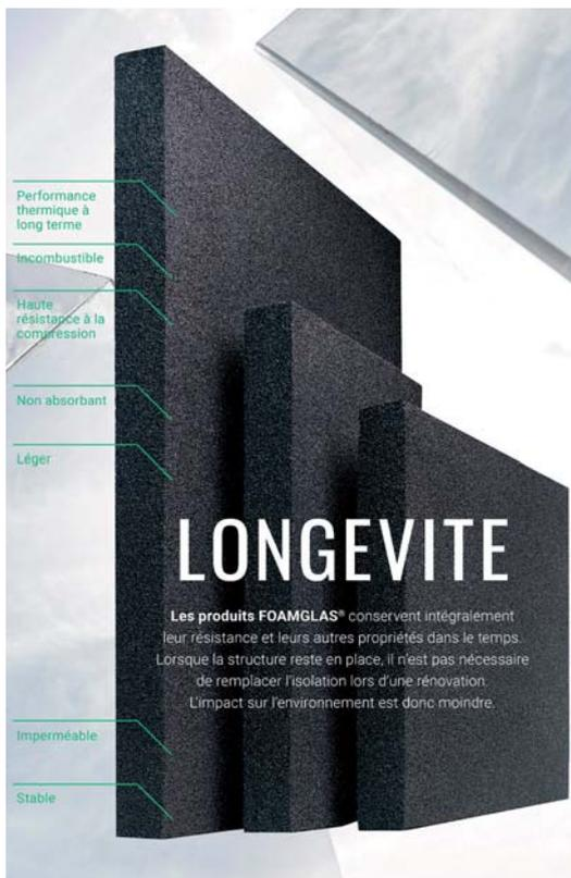
Parmi les nombreux isolants disponibles sur le marché, le verre cellulaire FOAMGLAS® se distingue par ses qualités techniques hautement performantes. Fabriqué à partir de verre recyclé à 66 % et d'autres matières minérales, par moussage à haute température en présence de carbone, FOAMGLAS® est constitué de petites bulles de verre 100 % étanches à l'air et à l'humidité. Il s'agit donc d'un matériau solide et stable qui présente une perméabilité nulle à l'humidité.
