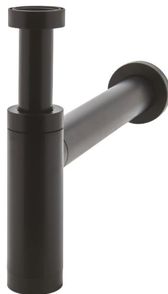
Doté d'une garde d'eau de 75 mm, il empêche efficacement la remontée des mauvaises odeurs. Son système de raccordement international convient à toutes les configurations de lavabos : sortie universelle à emboîter ou à coller en diamètre 32 ou 40 mm. Réglable en hauteur, le nouveau siphon TEOS est facile à installer et s'adapte à toutes les installations.
