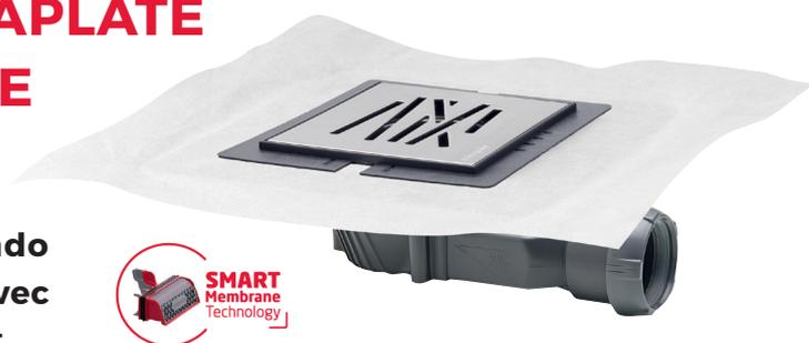
Durable et garantie 10 ans, elle est l'assurance d'une installation parfaitement sûre et sans fuite grâce à une natte d'étanchéité pré-collée avec débord de 50 mm pour une reprise d'étanchéité parfaite avec la chape. Renforcée avec du mortier et de la fibre, la platine en mousse polystyrène extrudée offre une installation fiable et résistante.
